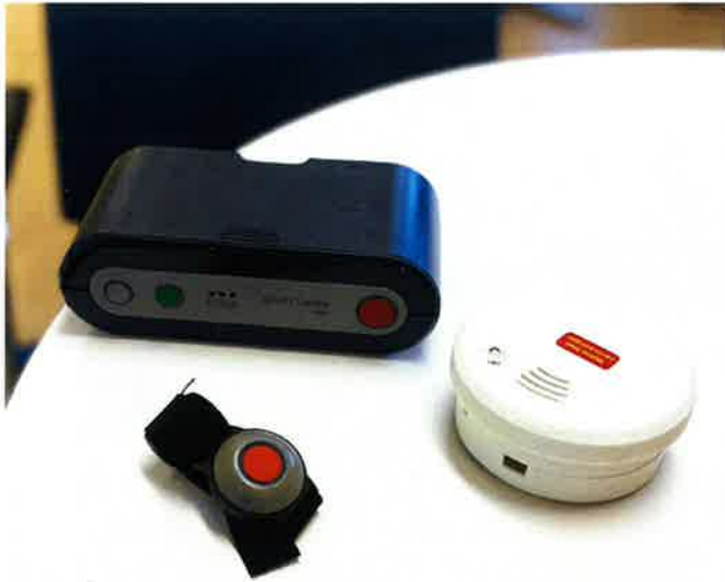
Brandvarnare kopplad till trygghetslarm.
